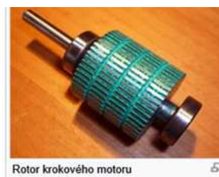
Obr. P4.14 Příklad součástí vícefázového krokového motoru s malým krokem (zdroj: Wikipedia)
