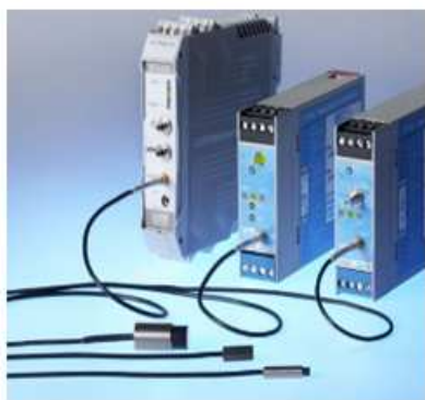
Obr. P10.11 Příklad komerčně dodávaných souprav pro měření vzdálenosti mezi senzorem a tělesem pomocí vířivých proudů
