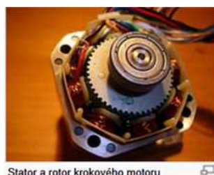
Obr. P4.14 Příklad součástí vícefázového krokového motoru s malým krokem (zdroj: Wikipedia)
