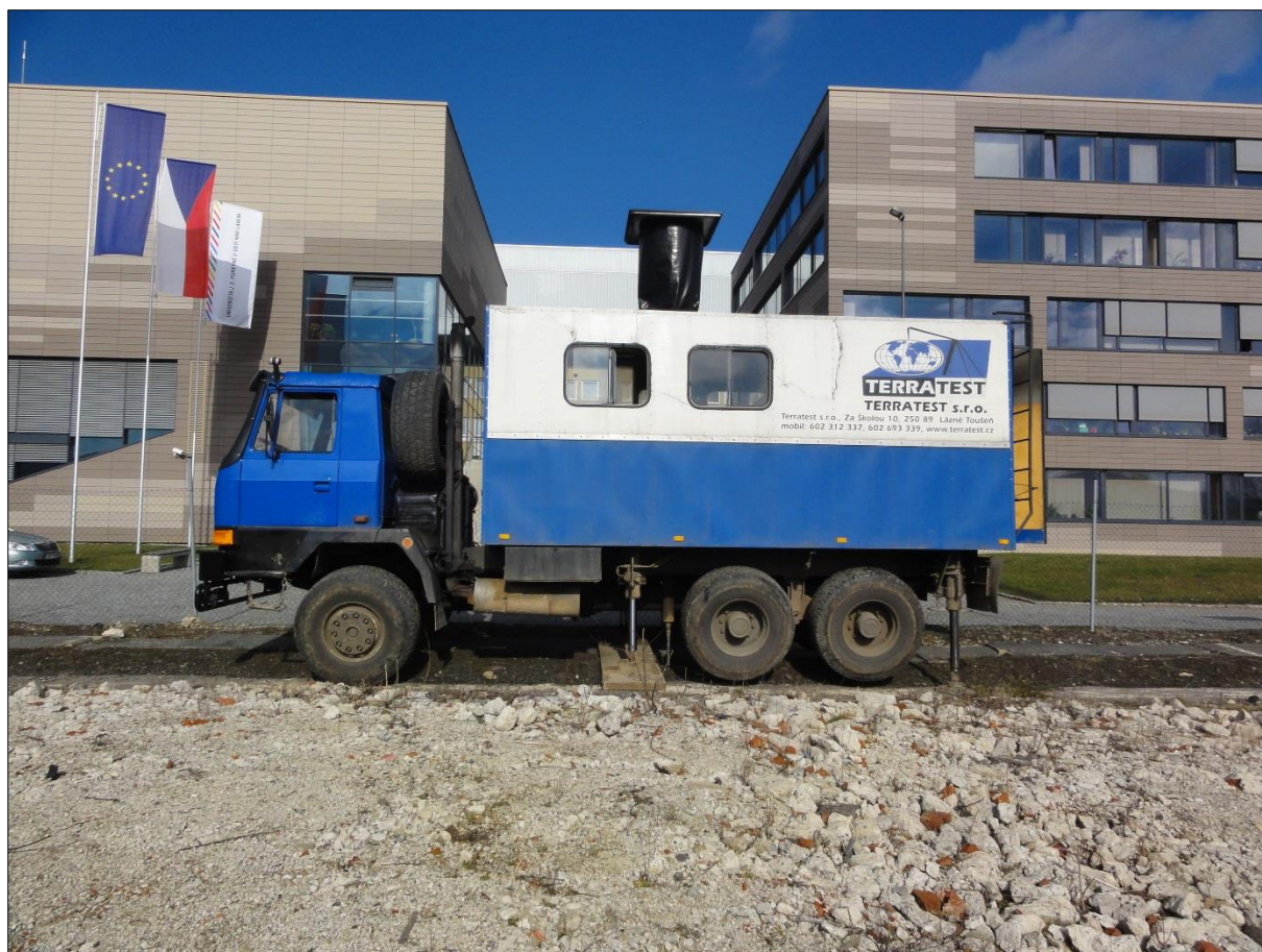
Obrázek 5: Provádění statické penetrační sondy SP2
